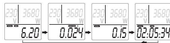
Celkovou dobu provozu lze vymazat v indikované funkci „TOTAL TIME“. Nastavte k tomu indikaci vpravo nahore (6) na „A“ a držte tlačítko „SET“ (8) stisknuto cca 3 s. Proces výmazu potvrzuje krátké pípnutí.
