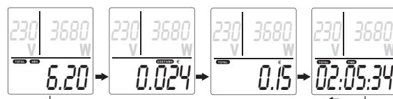
Die Gesamt-Betriebszeit kann in der angezeigten Funktion "TOTAL TIME" gelöscht werden. Stellen Sie dazu die Anzeige oben rechts (6) auf "A" und halten die Taste „SET“ (8) für ca. 3s gedrückt. Ein kurzer Piepton bestätigt den Löschkvorgang.
