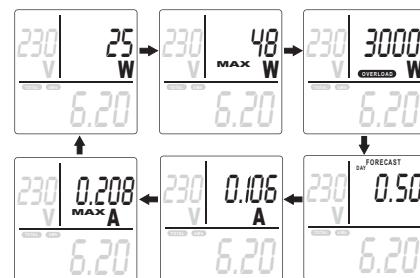
Stisknutím tlačítka „SET“ (8) cca 3 sekundy lze vymazat max. hodnoty v příslušné indikaci. Proces výmazu potvrzuje krátké pípnutí.
