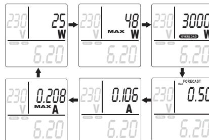
Die MAX-Werte können in der jeweiligen Anzeige gelöscht werden, indem die Taste „SET“ (8) für ca. 3s gedrückt wird. Ein kurzer Piepton bestätigt den Löschkvorgang.
